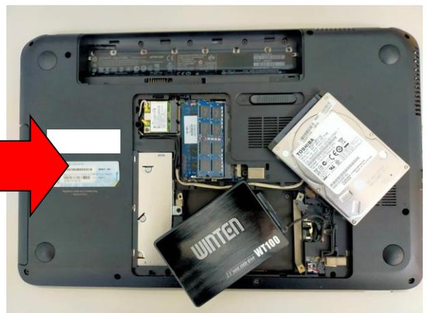
古いパソコンのハードディスクを最新のSSDに交換し、メモリを増設します。後は、パソコンを調整し、最新の機種に負けないくらいの速度と安定性が得られます。
